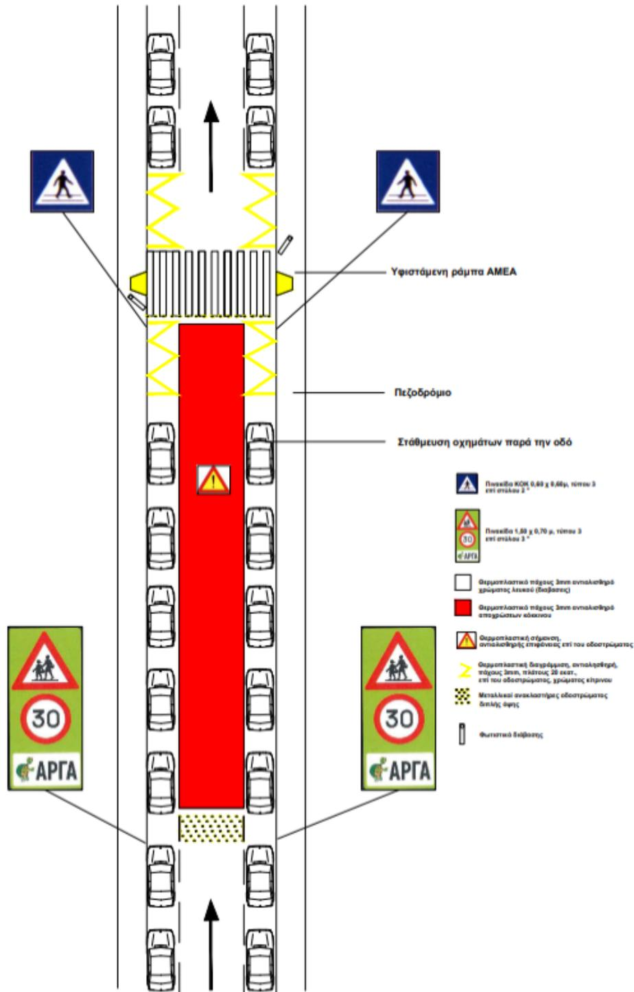
Η χρήση του θερμοπλαστικού υλικού χρώματος κόκκινου, θα εφαρμόζεται καθ' υπόδειξη της Δ/σης Τεχνικών Υπηρεσιών, καθώς κάθε διάβαση και κάθε διασταύρωση, έχει τα δικά της γεωμετρικά χαρακτηριστικά που χρήζουν προσαρμογή του εύρους των παρεμβάσεων.
